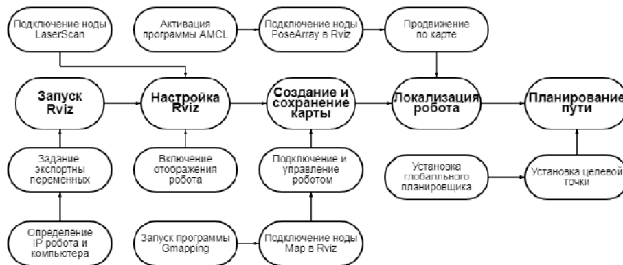
Рис. 4. Структурная схема управления и навигации мобильным роботом
